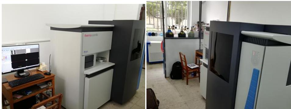
X 射线光电子能谱仪 (XPS) 系统 Thermo Scientific™ (2020 年)
