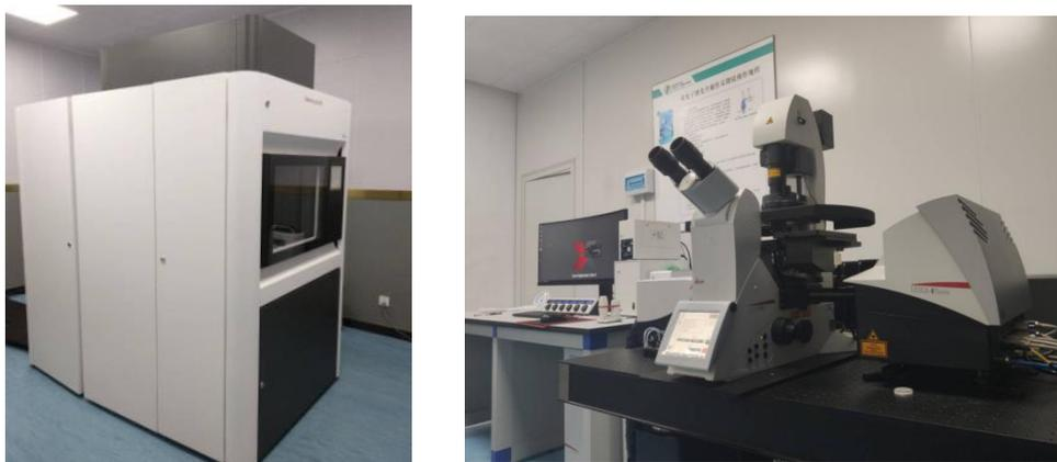
透射电子显微镜双光子激光共聚焦显微镜（2019年）
